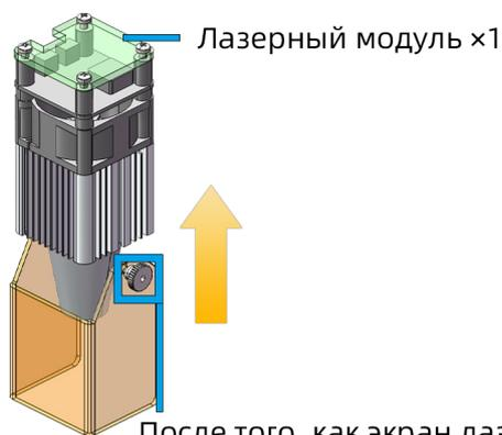
После того, как экран лазера вставлен, затяните винты, стараясь не затягивать их слишком сильно.
