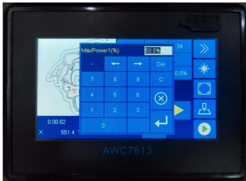
Figure3-10-1-2 Modify the mini laser power
