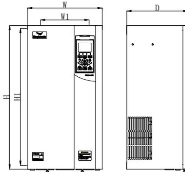
Type III suitable model: V800-4T3500G/4T4000P ~ V800-4T8000G/4T9000P
